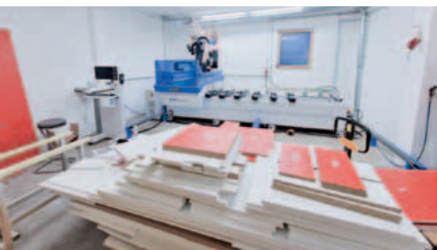
4-osni CNC KDT tip 6410C, savremeno opremljen inovativnim TPA softverom (Italija).
